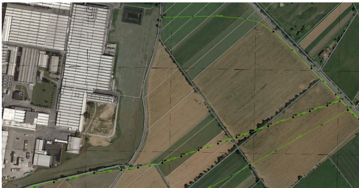
Figura 26: Raccordo dei canali Michelin che scaricano in pubblica fognatura
