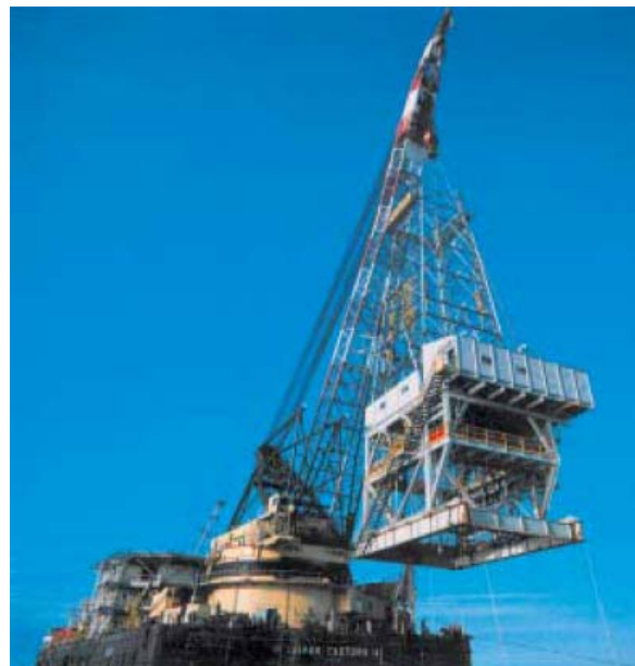
Figura 1.20 - Immagini del Mezzo Navale di Sollevamento tipo Crane-Barge
