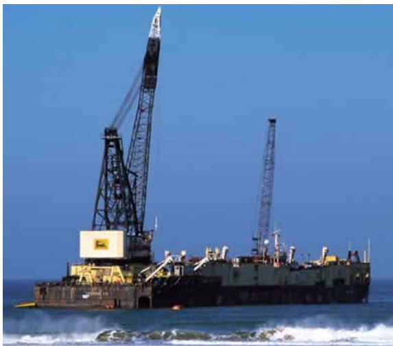
Figura 1.20 - Immagini del Mezzo Navale di Sollevamento tipo Crane-Barge
