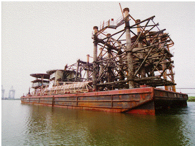
Figura 2.26 - Trasporto delle Strutture Rimosse
