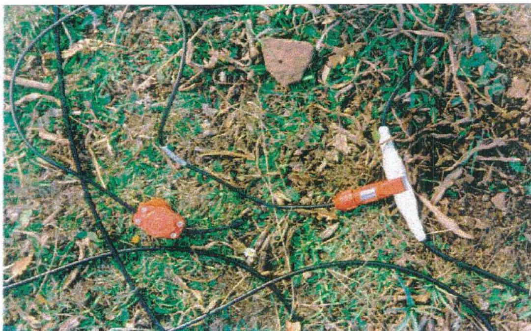
FOTO n° 9 - Geofono 14Hz di linea per acquisizione a rifrazione. Dettaglio sulla connessione al relativo cavo sismico.
