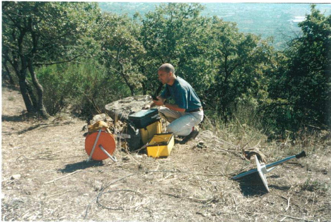
Foto 4 - Particolare del sismografo Smartseis a 24 canali e relativo cannoncino sismico a pallettoni (fase di verifica dei geofoni sulla linea a riflessione).
