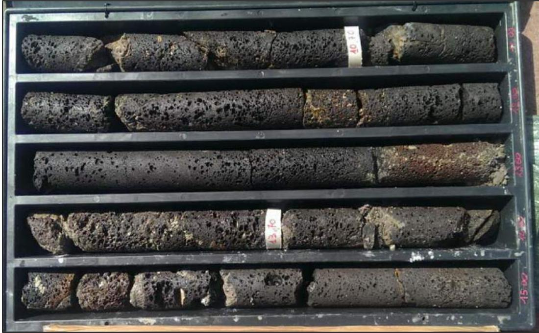
Foto 4 – Basalti della Campeda-Planargia appartenenti alla Subunità di Campeda, incontrati nel sondaggio S5 (Sonedile s.r.l. – 2015) in corrispondenza del ponte in progetto sul Riu Temu.
