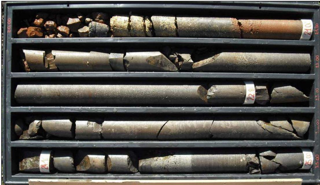
Foto 2 – Depositi piroclastici e ignimbritici appartenente all'Unità di Macomer, incontrati lungo il sondaggio S26 (Sondedile s.r.l. – 2015) nelle vicinanze del nuovo svincolo di Mulargia-Macomer al Km 148+500.
