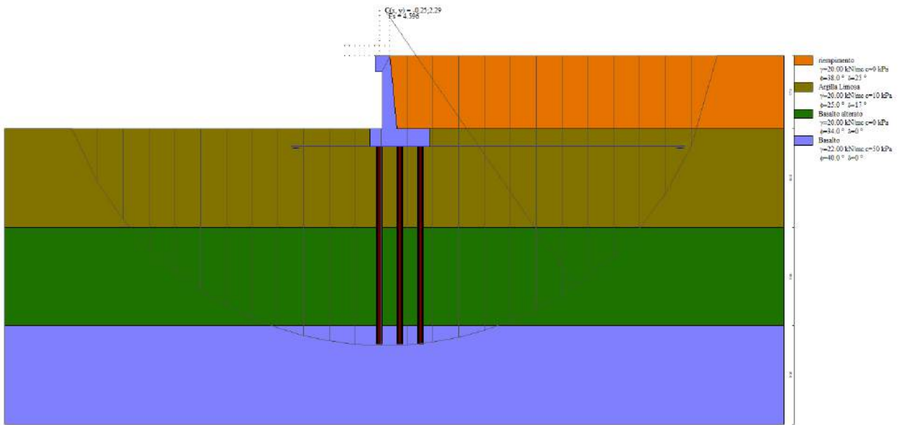
Figura 80 – Verifica in condizioni sismiche (Sisma +)
