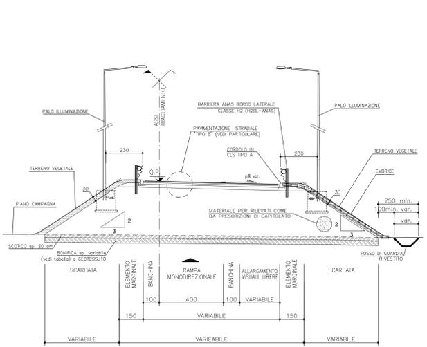
**SEZIONE TIPO IN RILEVATO IN RETTIFILLO**
