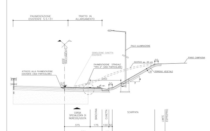
**SEZIONE TIPO IN RILEVATO**
