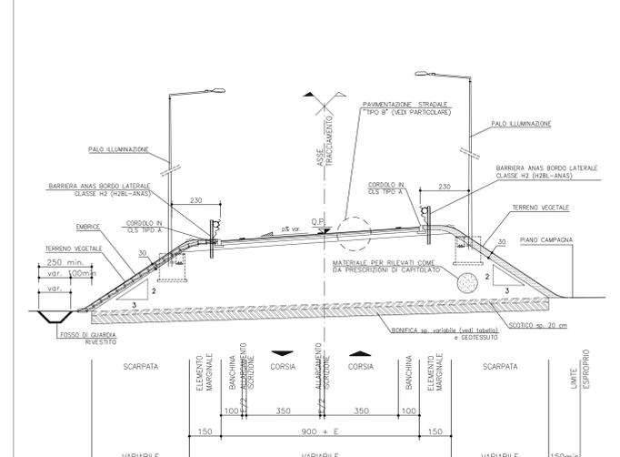
**SEZIONE TIPO IN RILEVATO IN CURVA con allargamenti per visuale e iscrizione**
