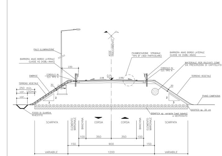
**SEZIONE TIPO IN RILEVATO IN CURVA con allargamento per iscrizione**
