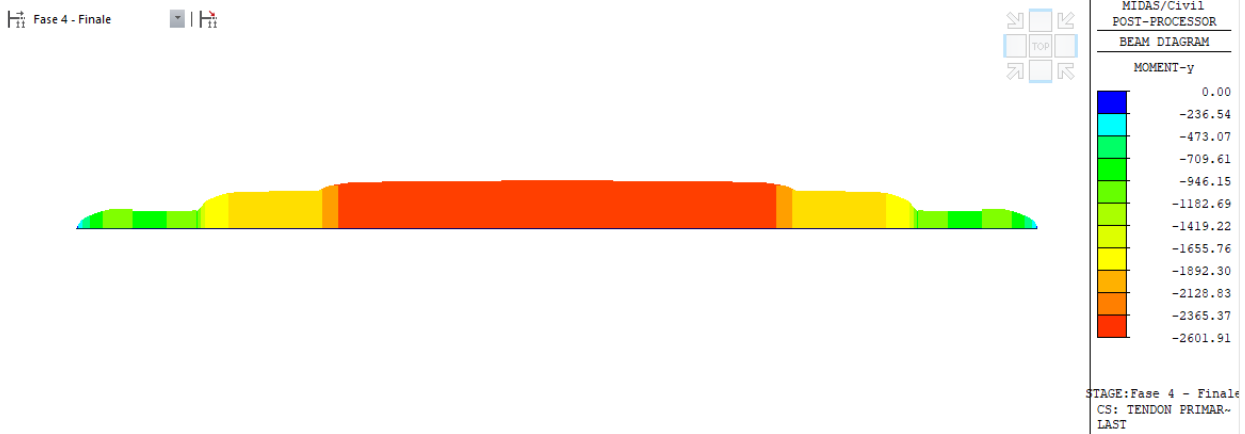
Figura 12-6 Effetto della precompressione – Sollecitazioni di momento flettente
