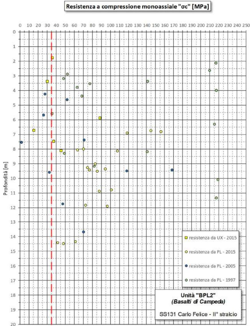
**Figura 7 – Basalti di Campeda – Resistenza a compressione uniassiale**
