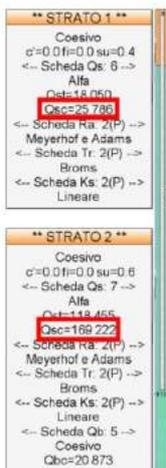
Si noti che il calcolo delle portate è stato effettuato in un caso di carico "fittizio", che non prevede coefficienti di sicurezza sulle caratteristiche meccaniche del terreno o sulle resistenze, per poter confrontare i risultati col caso "teorico - ideale" analizzato dall'Autore.
