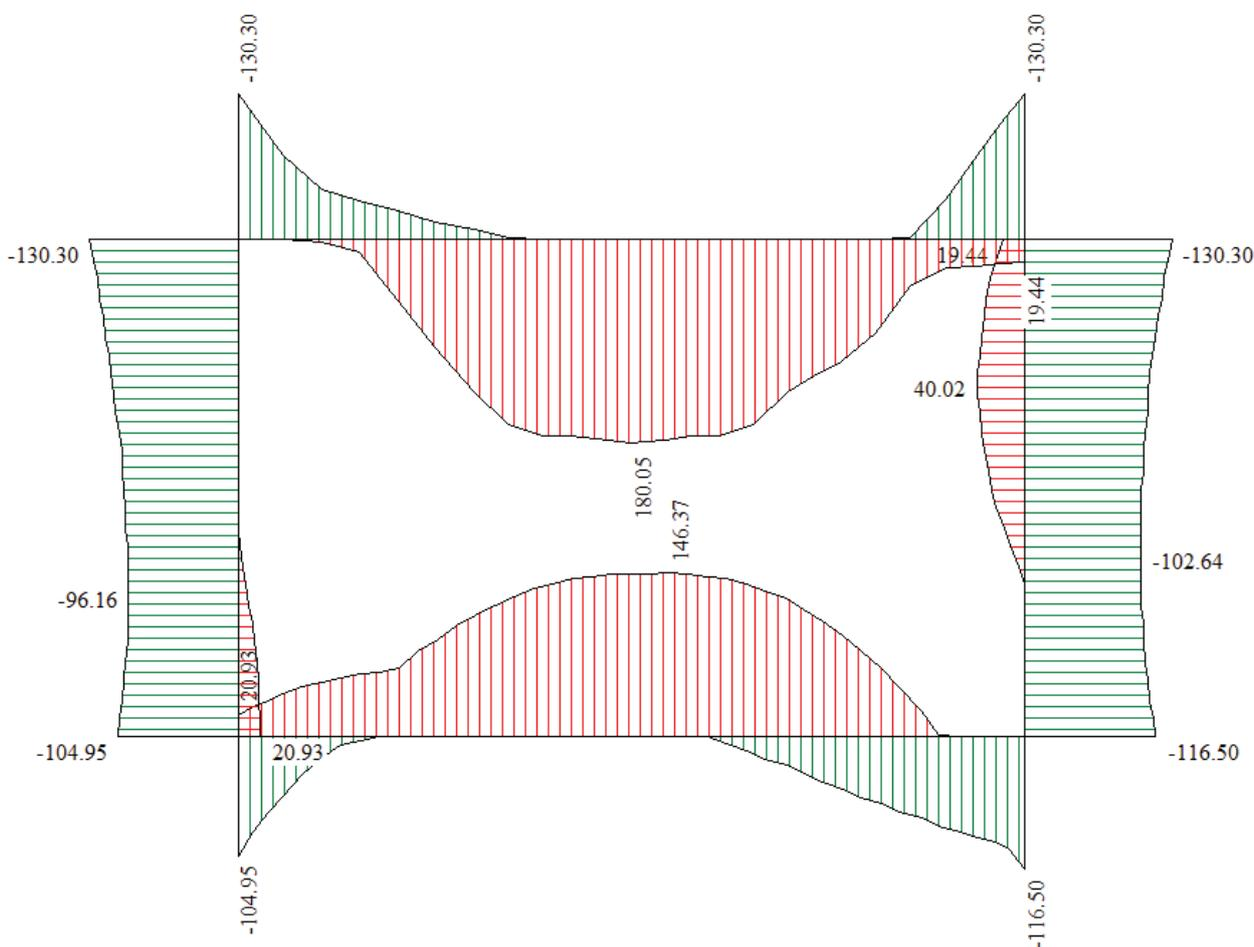
Figura 15 – Involuppo del diagramma del momento
