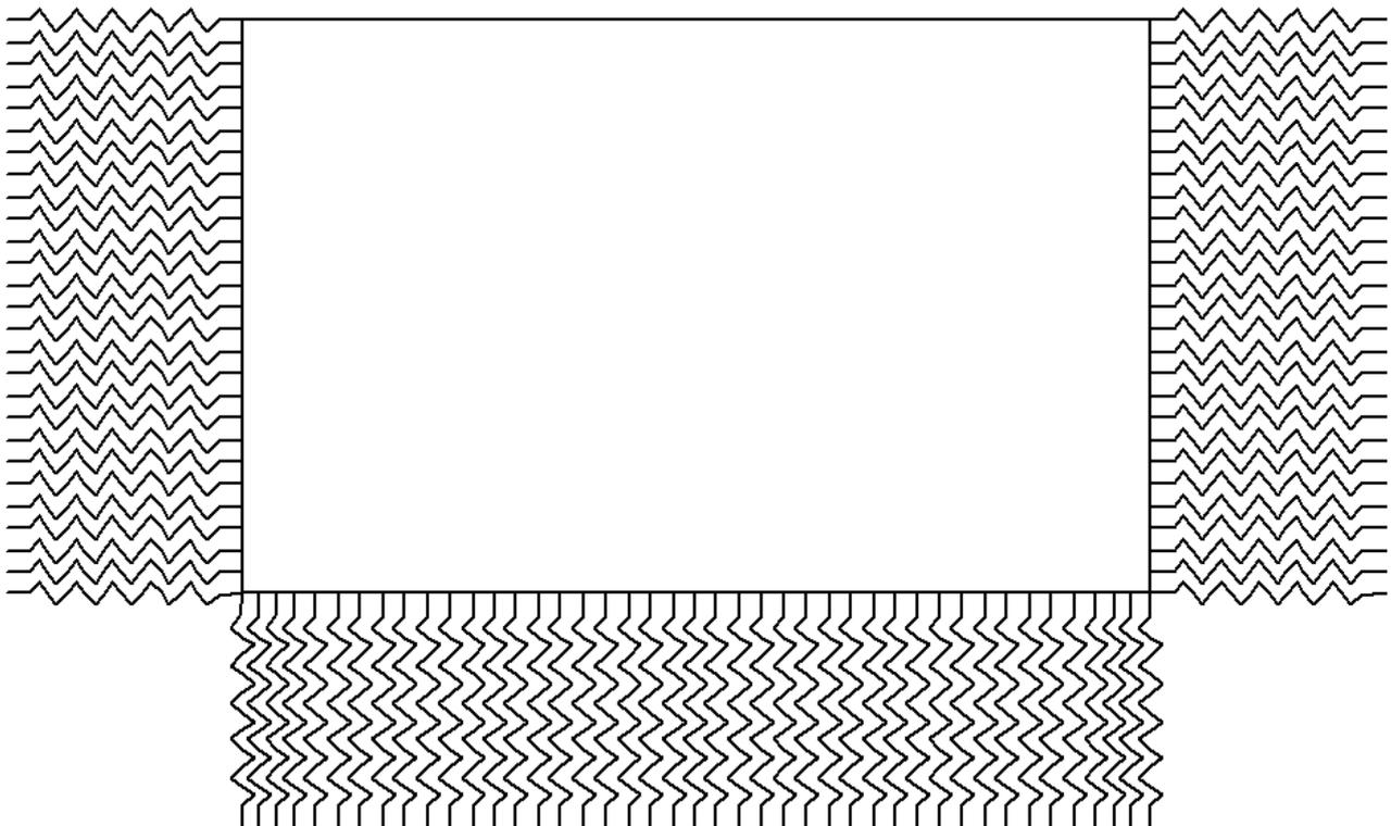
Figura 3 – Schematizzazione del terreno mediante molle
