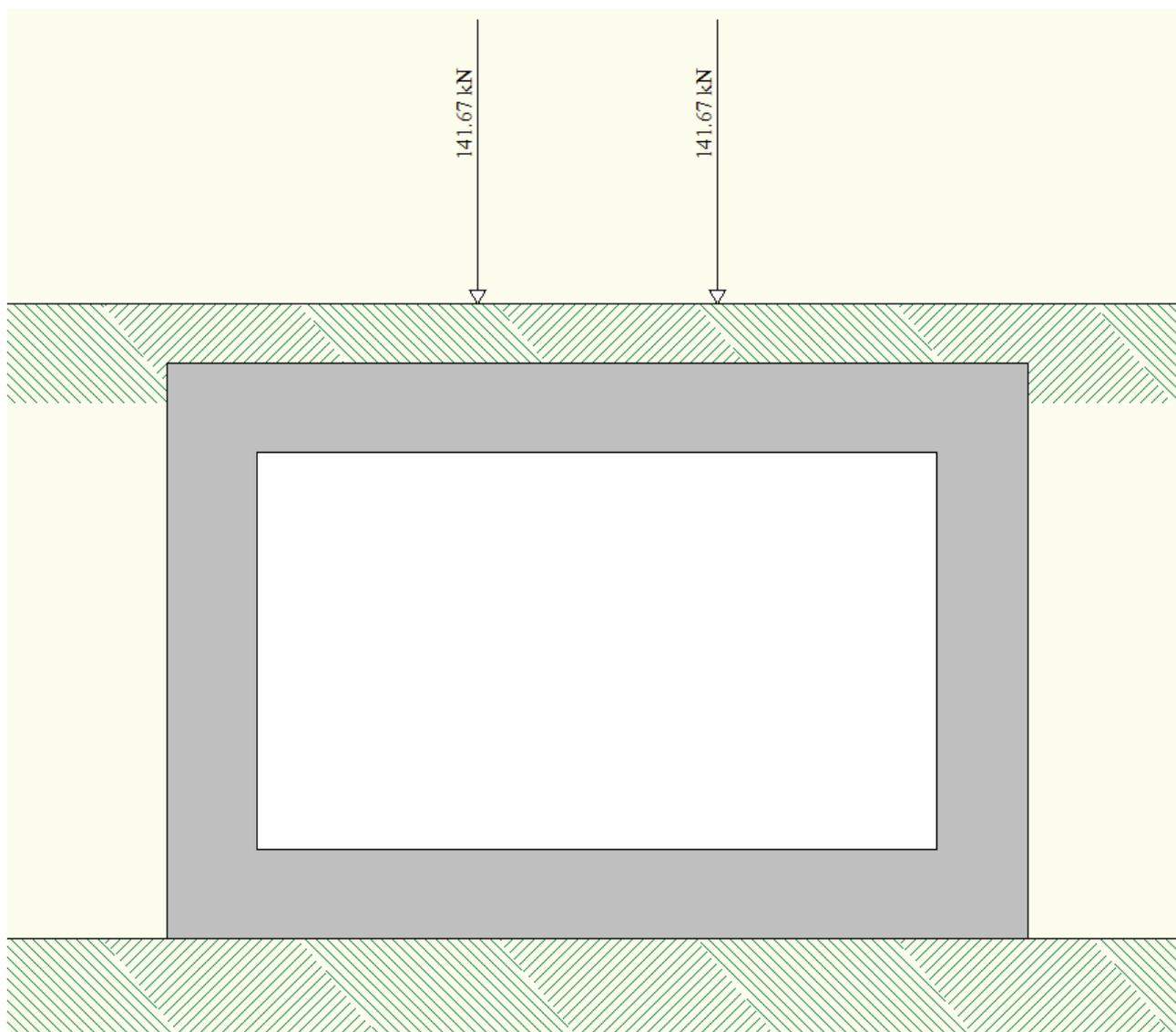
Figura 9 – Gruppo 1 – carico tandem (condizione di carico n°8)
