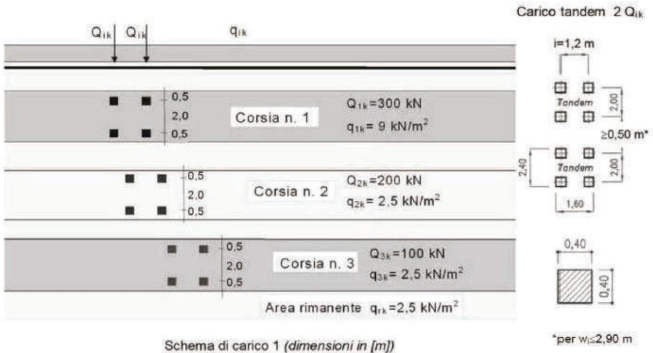
Figura 5 – Schema di carico 1 (Fig.5.1.2 NTC 2018)
