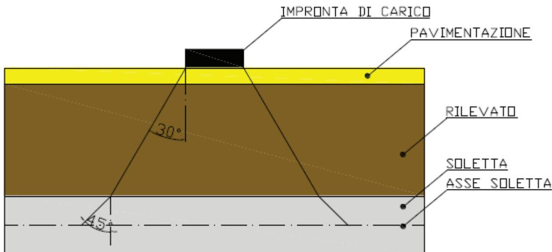
Figura 6 – Schema di diffusione dei carichi concentrati
