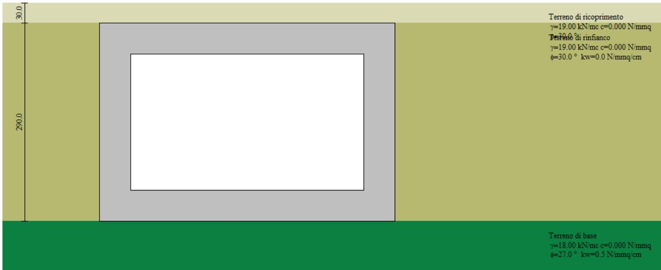
Figura 2 – Stratigrafia e caratteristiche del terreno
