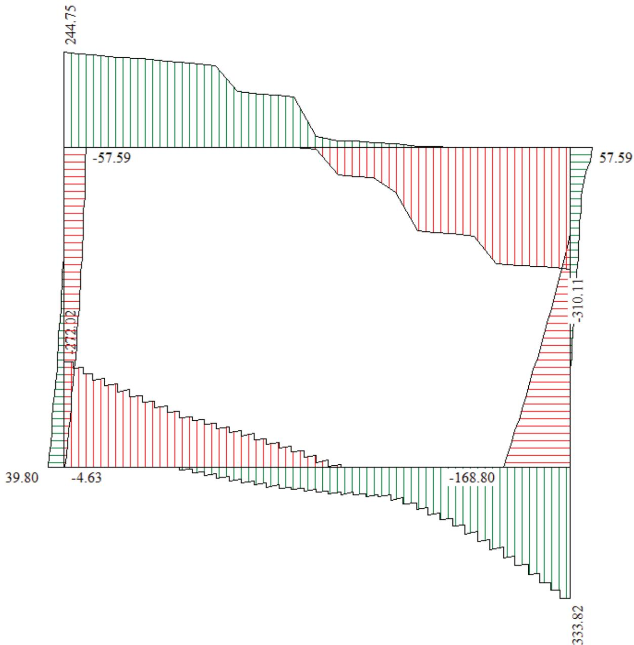
Figura 16 – Inviluppo del diagramma del taglio
