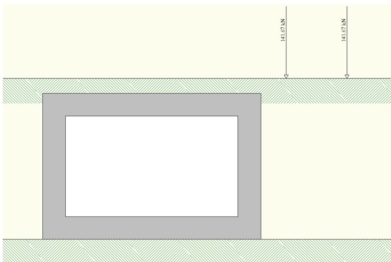
Figura 13 – Gruppo 3 – carico tandem (condizione di carico n°10)
