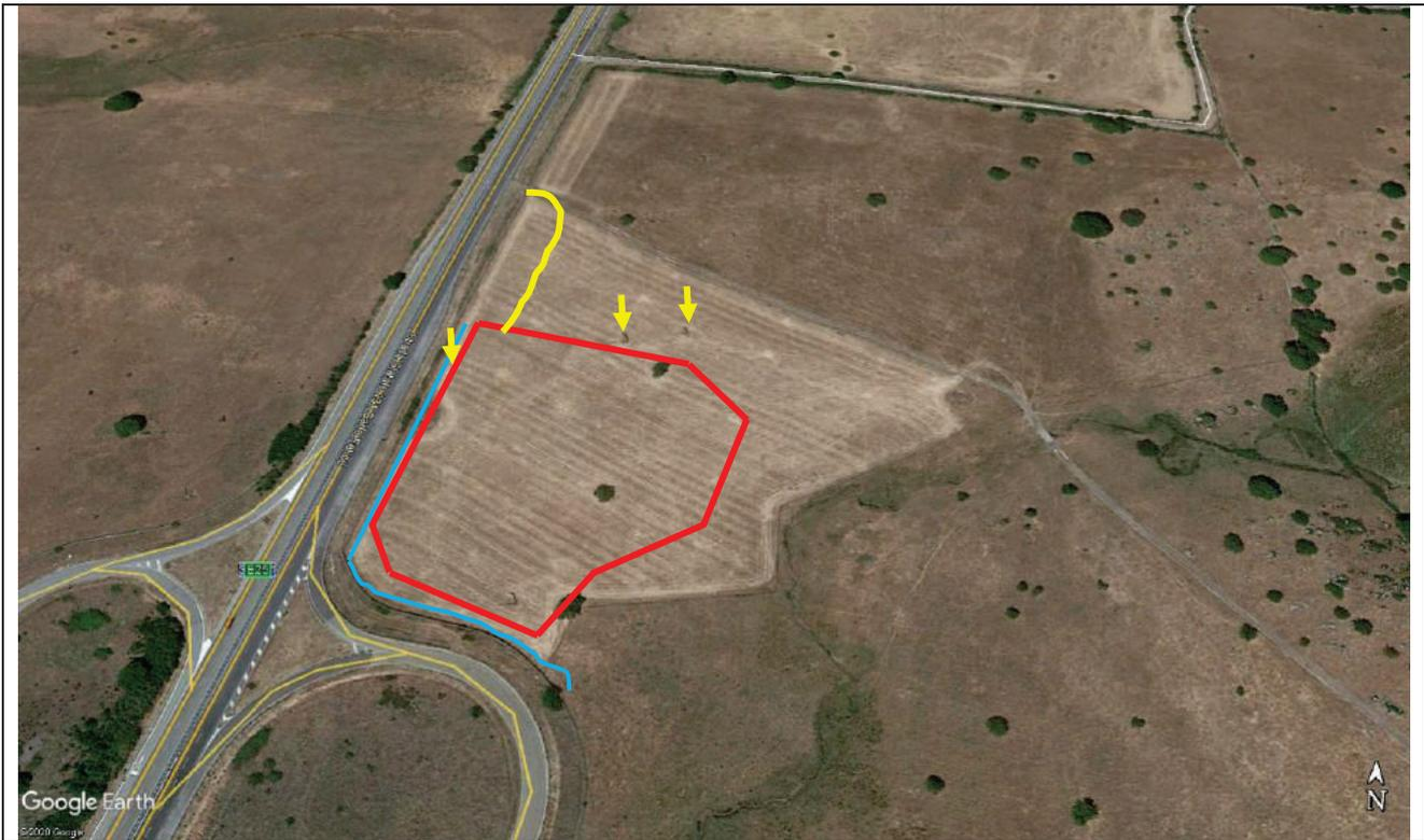
**FOTO 12** - Panoramica generale dell'area del Campo Operativo CO.05 (perimetro in rosso); in giallo è invece riportato l'accesso dalla rampa di collegamento sulla SS131 con la relativa pista. Le frecce in giallo indicano i sostegni metallici della linea elettrica in MT (esterni al perimetro del campo operativo). La linea ciano individua i muri in pietrame a secco che saranno mantenuti esterni al perimetro del cantiere.
