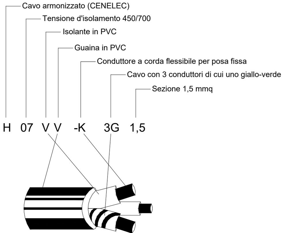
Relazione di calcolo e dimensionamento cavi
