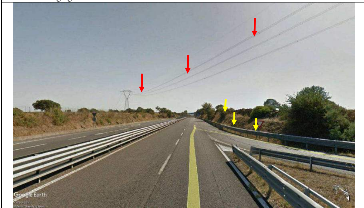
Foto 23a - Panoramica accesso Nuraghe Losa che evidenzia l'intreferenza con la linea TERNA (freccie in rosso) e la scarpata con arbusti e barriera di sicuerzza (freccie gialle)
