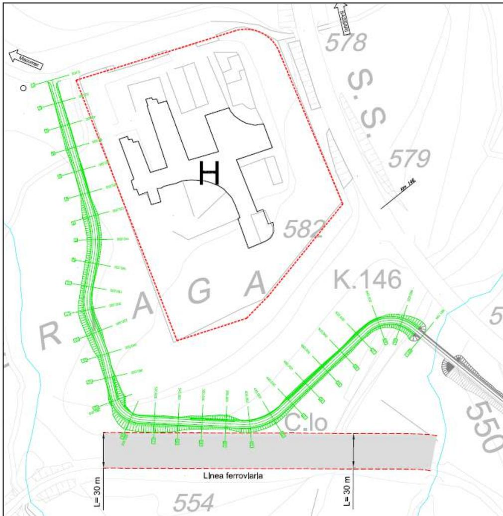
Figura 15 - Il tracciato si colloca al di fuori della fascia di inedificabilità ferroviaria di 30 m DPR n. 753/1980
