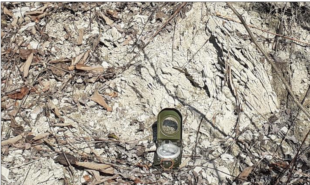
Figura 8 – Affioramento di marne calcaree fittamente fogliettate e tettonizzate del Membro di Genepreto (Formazione della Val Luretta) sul versante presso Fabbiano-località Molinasso vallone dell'Acqua Rossa
