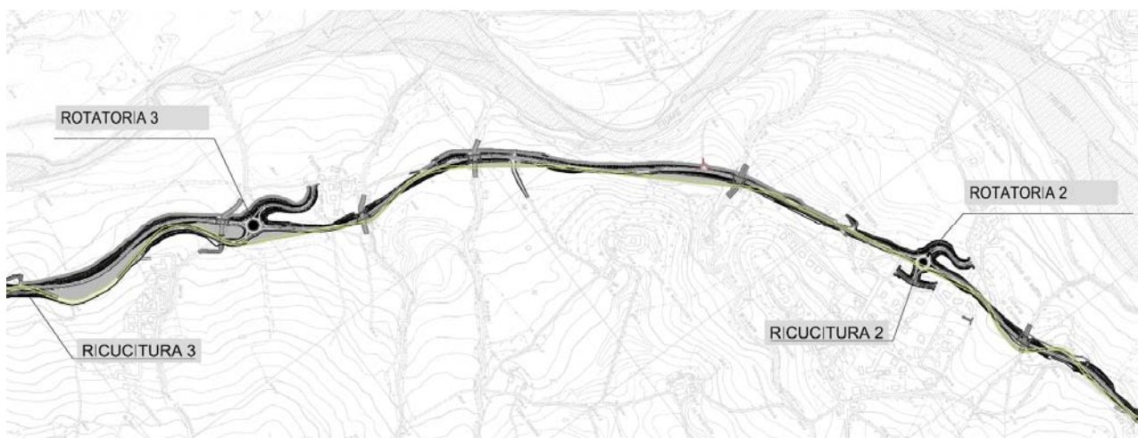
Figura 8 - Stralcio planimetrico dell'asse 3. Il tracciato dell'attuale asse della SS.45 è in verde.
