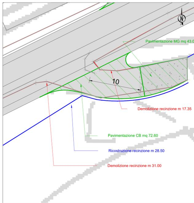
INNESTO 40 - Planimetria demolizione e ricostruzione scala 1:200
