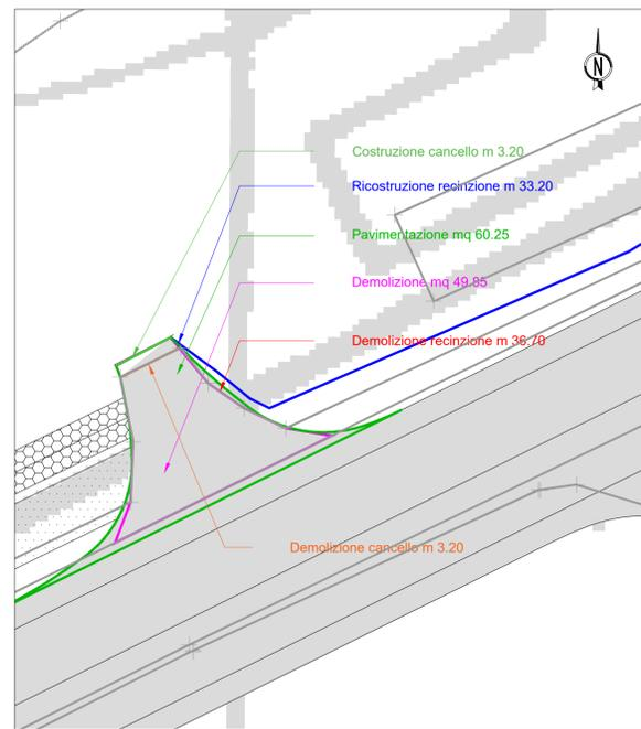
INNESTO 41 - Planimetria demolizione e ricostruzione scala 1:200
