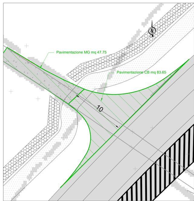
INNESTO 44 - Planimetria demolizione e ricostruzione scala 1:200
