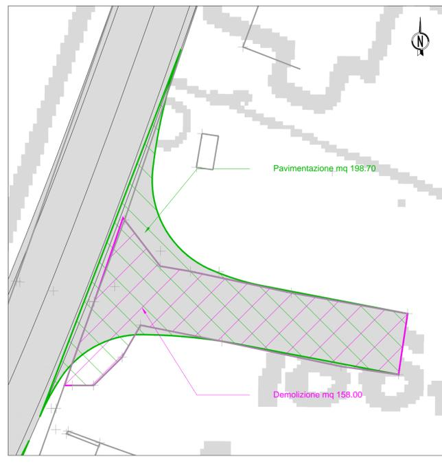
INNESTO 62 - Planimetria demolizione e ricostruzione scala 1:200
