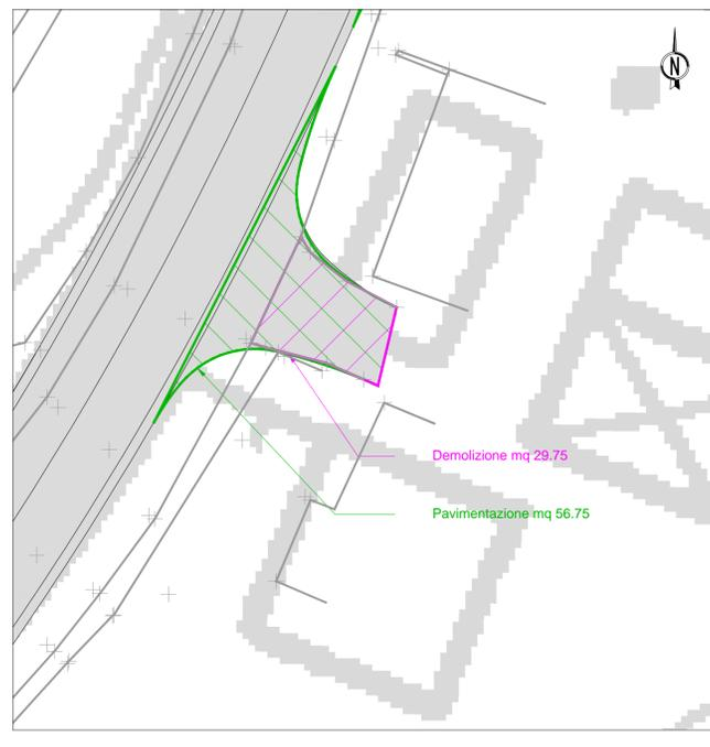
INNESTO 64 - Planimetria demolizione e ricostruzione scala 1:200
