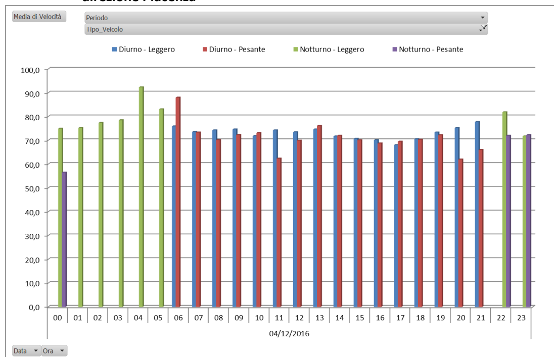
Graf. 4.4 - Distribuzione delle velocità medie sull'ora, classificate per tipologia di veicolo e periodo di riferimento, per il giorno festivo della domenica, sezione T2 direzione Piacenza
