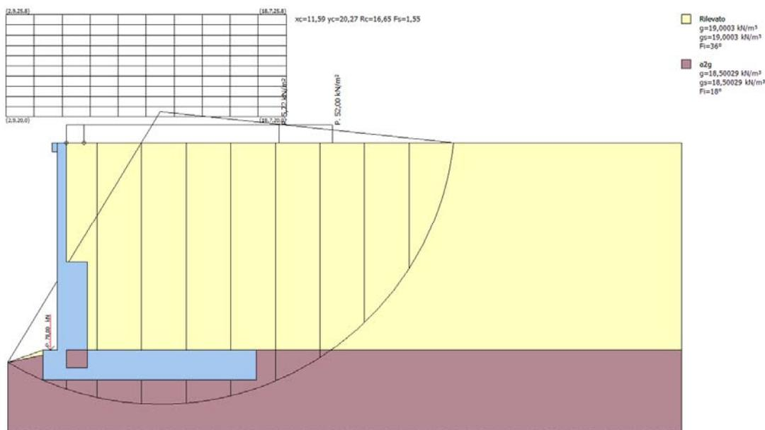
Fig. 8c Modello di calcolo concio 19 (condizione statica)
