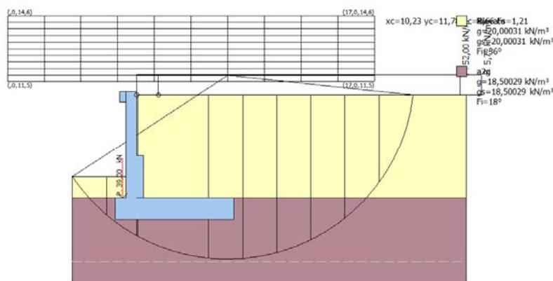
Fig. 8a Modello di calcolo conico 1 (condizione statica)
