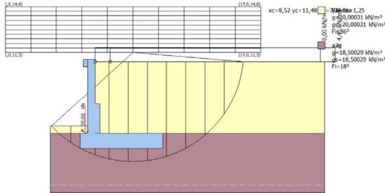
Fig. 8a Modello di calcolo concio 1 (condizione sismica)
