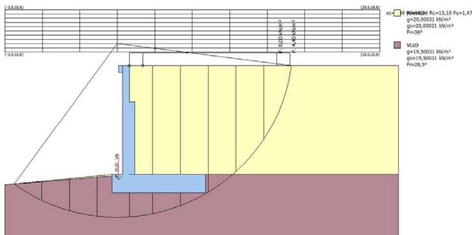
Fig. 8b Modello di calcolo concio 25 (condizione sismica)
