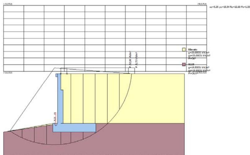
Fig. 8a Modello di calcolo concio 28 (condizione statica)
