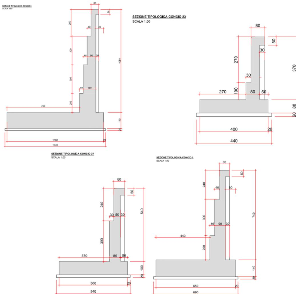
Fig. 1 Sezione trasversale conci tipo
