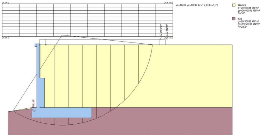
Fig. 8a Modello di calcolo concio tipo 1080 (condizione statica)
