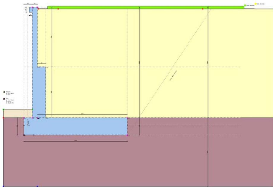
Fig. 7a Modello di calcolo concio tipo h 1080
