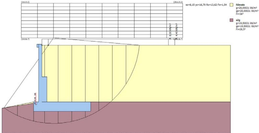
Fig. 8b Modello di calcolo concio tipo 920 (condizione sismica)
