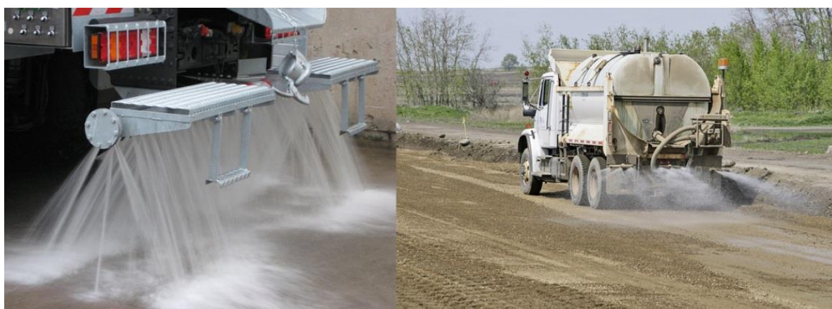
Figura 8-1: Automezzo per la bagnatura delle piste sterrate
