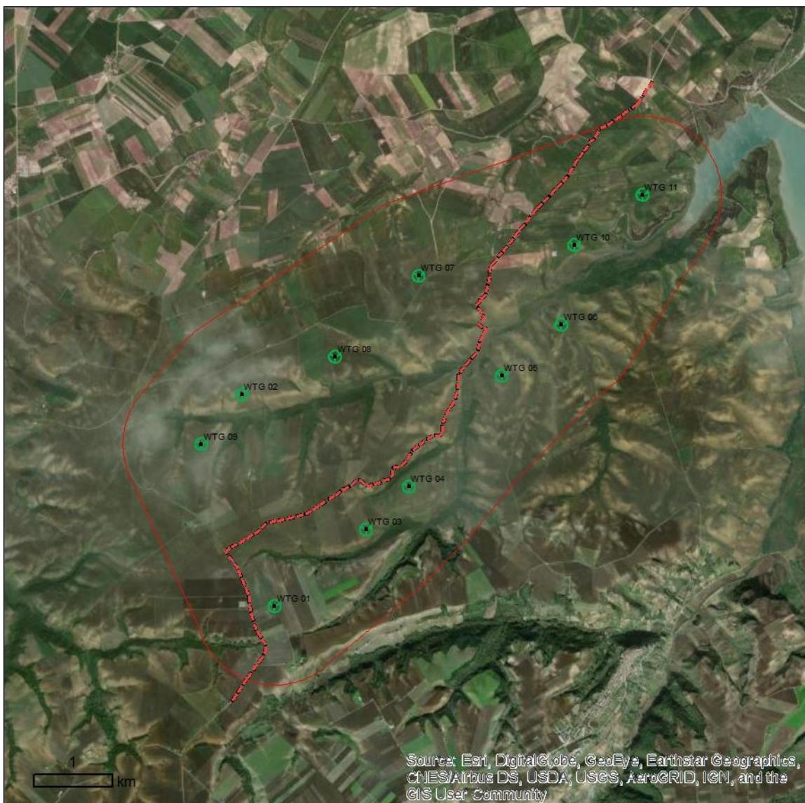
Figura 5 – Layout aerogeneratori, limiti dell’area di progetto (linea rossa continua) e transetto utilizzato per il rilievo avifaunistico (linea rossa tratteggiata).
