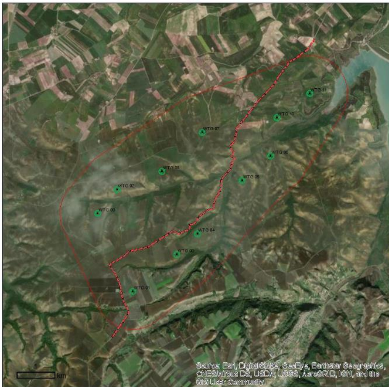
Figura 2-18: Layout aerogeneratori, limiti dell'area di progetto (linea rossa continua) e transetto utilizzato per il rilievo avifaunistico (linea rossa tratteggiata).
