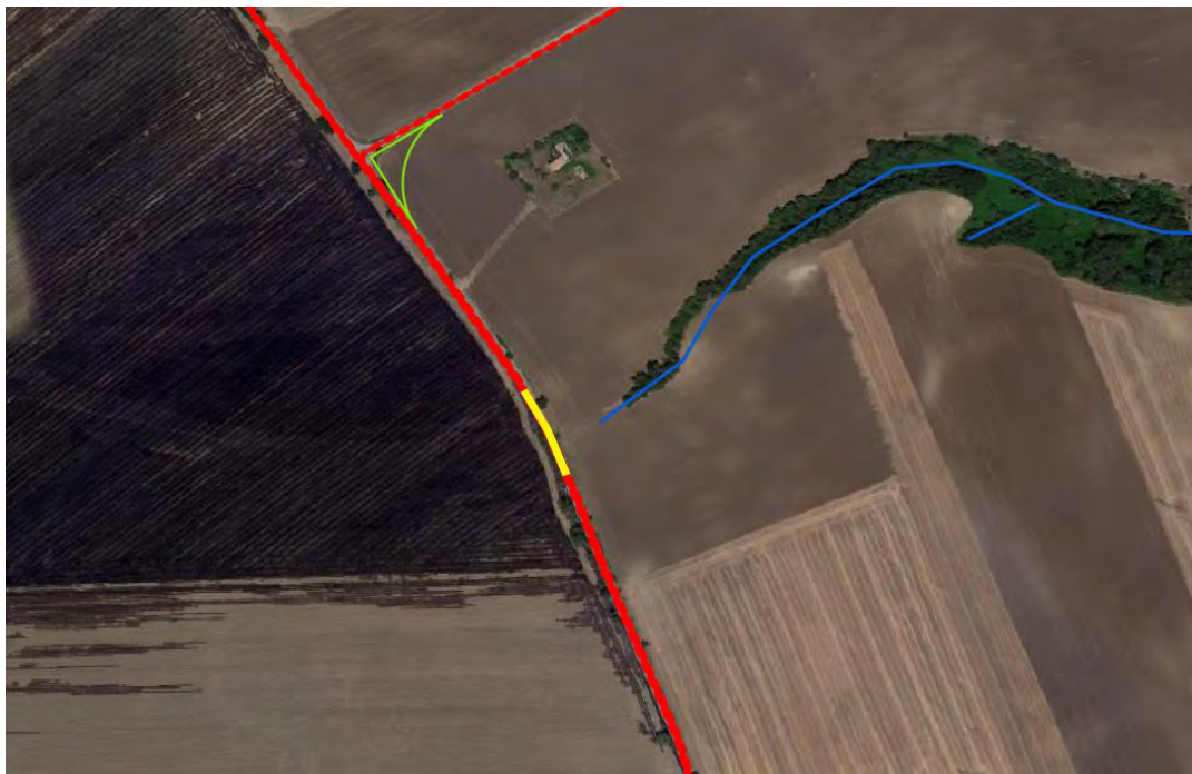
ATTRAVERSAMENTO 2: Cavidotto interno. intersezione con manufatto idraulico di attraversamento su SP 18
