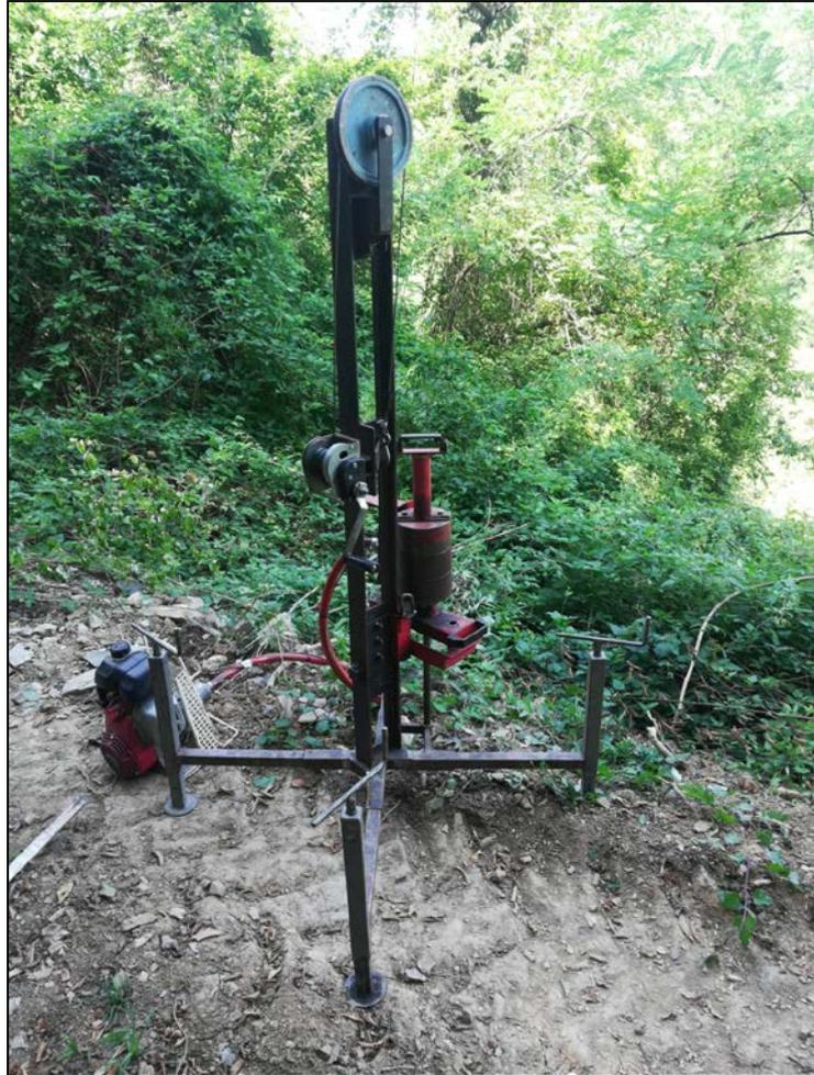
Prova penetrometrica dinamica DPM
