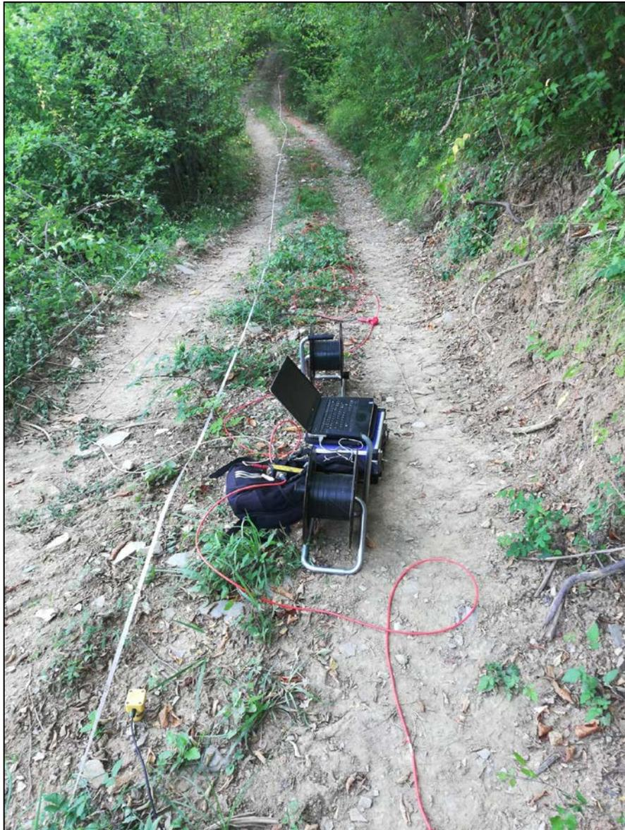
Stendimento sismico acquisizione MASW-REMI
