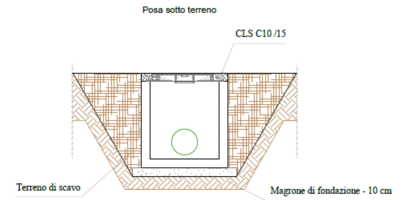
TIPICO Posa pozzetti Scala 1: 25
