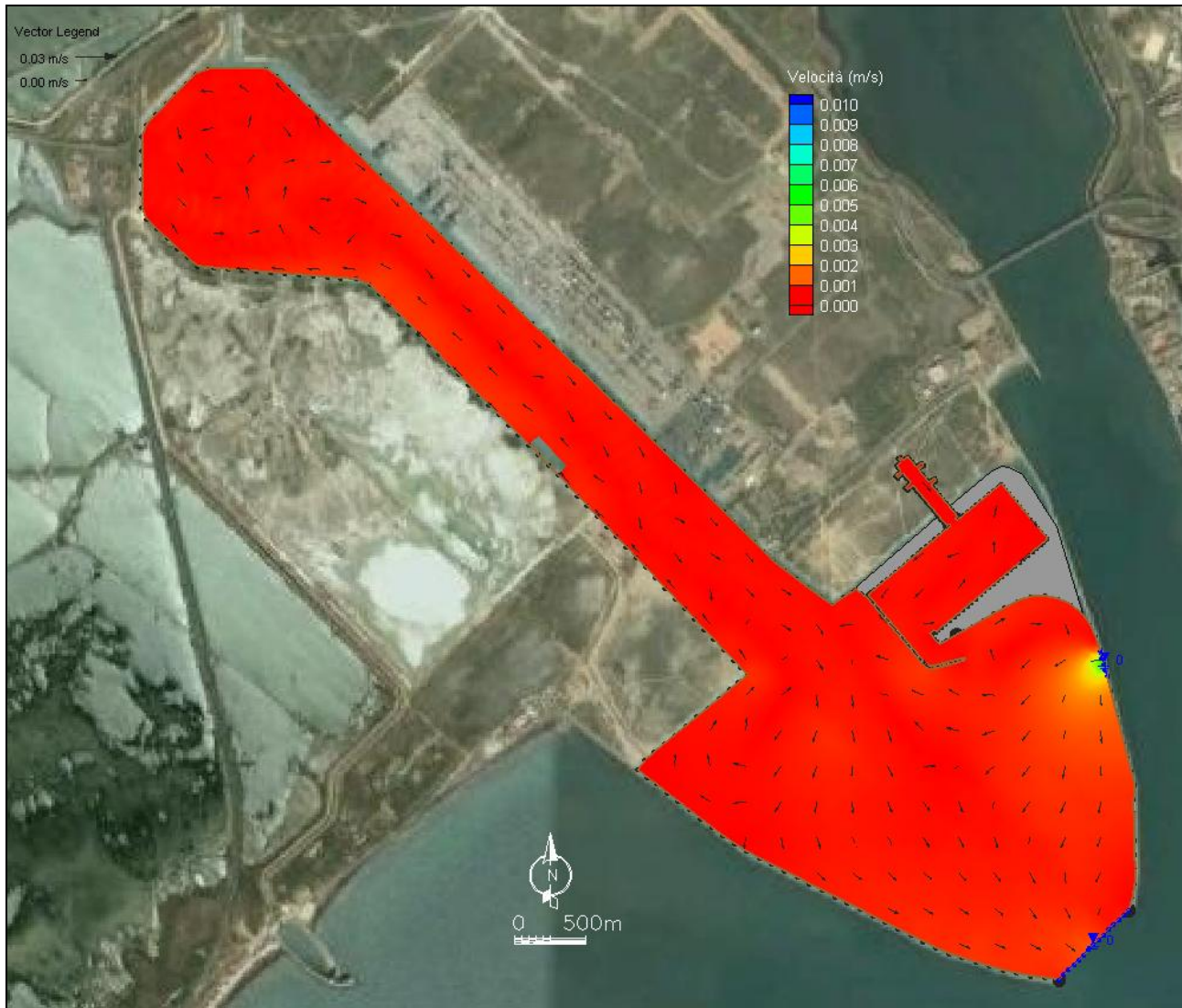
Figura 3.12 – Particolare del campo idrodinamico indotto dalla sola marea astronomica alle ore 21.00 (inversione del flusso).
