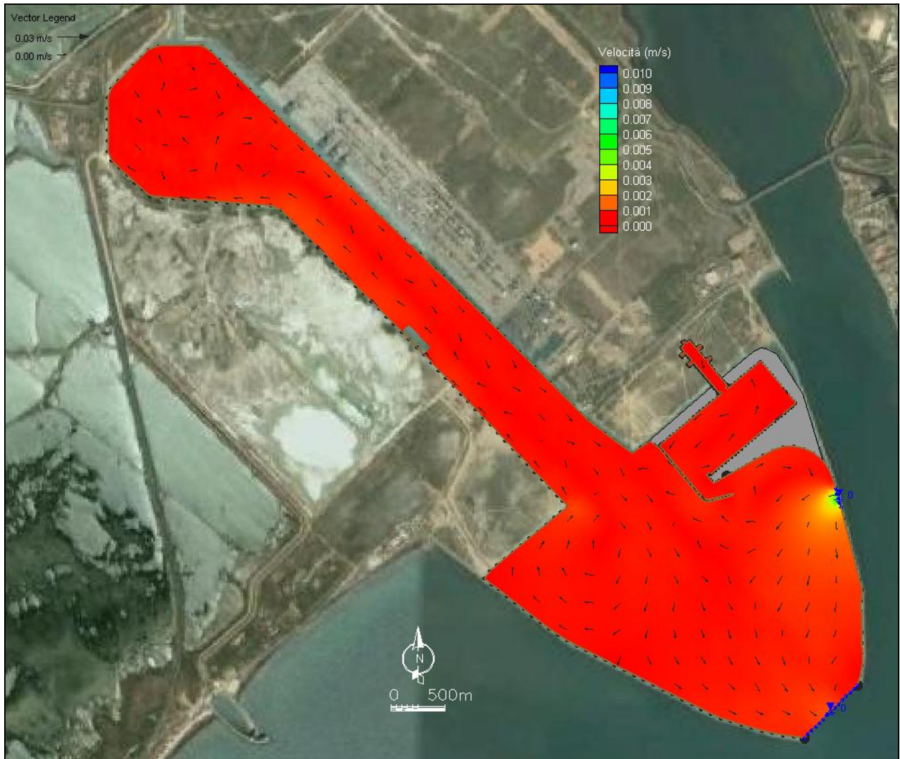
Figura 3.8 – Particolare del campo idrodinamico indotto dalla sola marea astronomica alle ore 9.00 (inversione del flusso).
