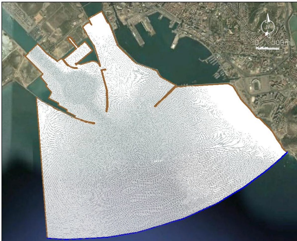
Figura 2.2 – Configurazione di progetto: discretizzazione dello specchio liquido
