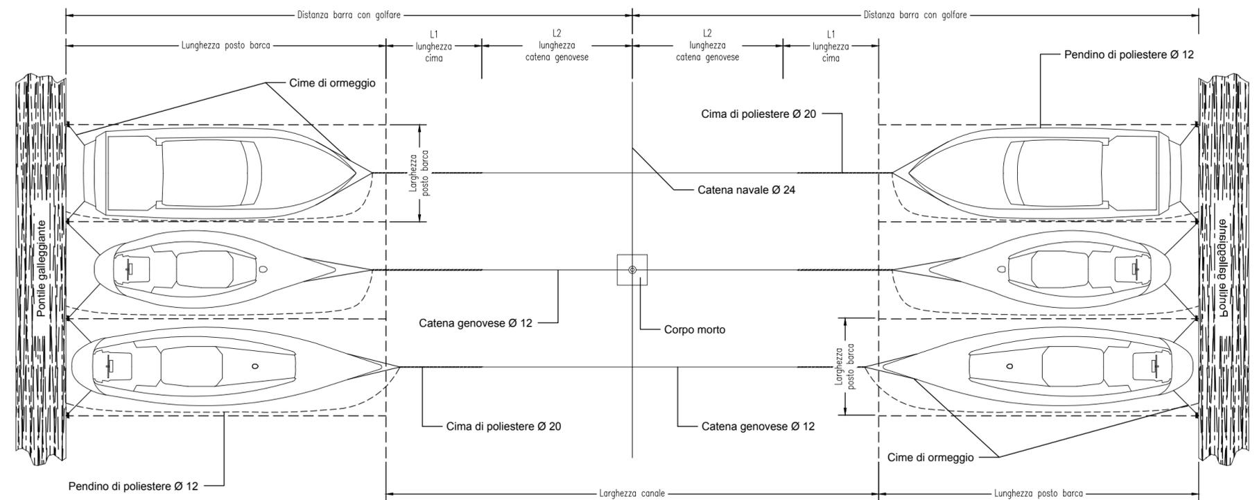
TUTTI I CORPI MORTI SONO DI CALCESTRUZZO ( $R_{ck} > 250 \text{ Kg/cm}^2$ ), FORNITI DI ANELLO ( $\text{Ø}30$ ) E SONO POSIZIONATI AL CENTRO DEL CANALE NAVIGABILE A DISTANZA UNO DALL' ALTRO DI CIRCA 12.5 m, E RISULTANO COLLEGATI CON UNA CATENA NAVALE ZINCATA A FUOCO AVENTE DIAMETRO  $\text{Ø}24$ .
