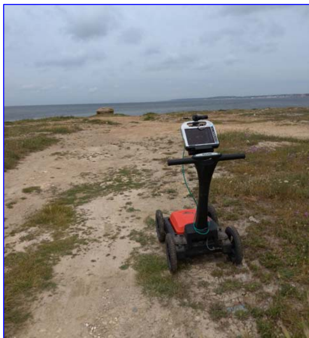
Fig.6 –Georadar SIR-4000 della GSSI Standard Survey Cart.
