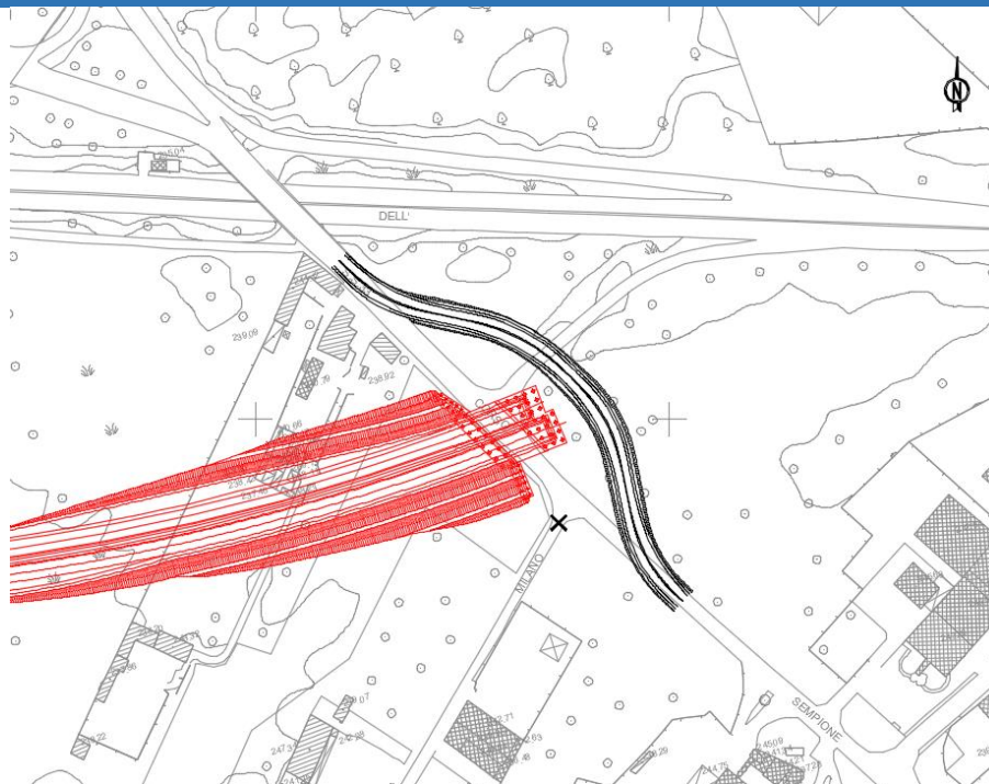
Figura 18 - Planimetria deviazione provvisoria su C.so Sempione (in nero) e aree in lavorazione (in rosso)
