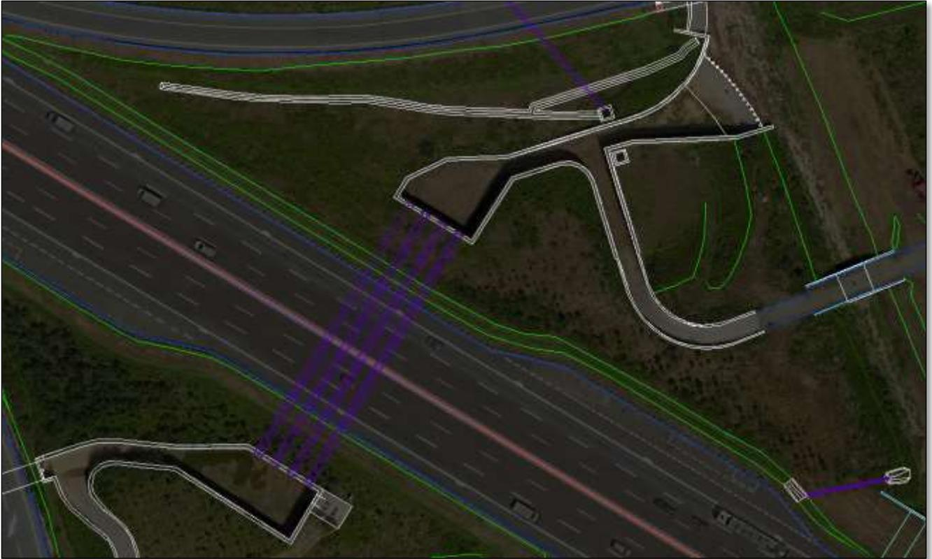
Particolare del rilievo sovrapposto all'ortofoto dell'opera idraulica di attraversamento dell'A8
