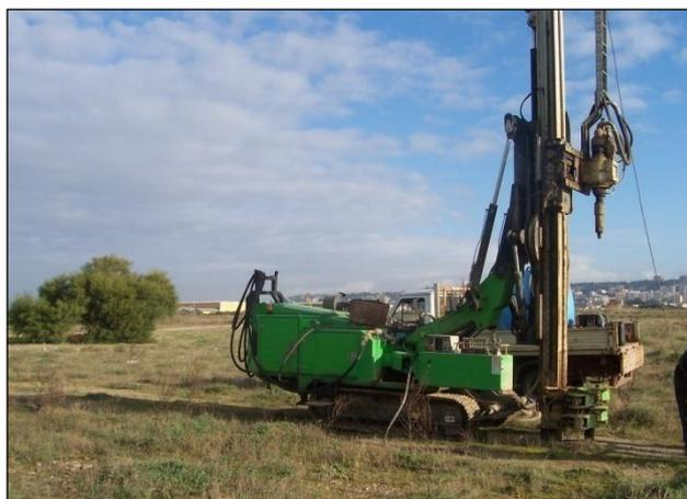
**Foto 4-1 Sonda utilizzata per le trivellazioni**
