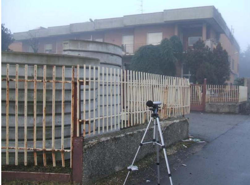
*Posizionamento del fonometro presso il ricettore PF1*
