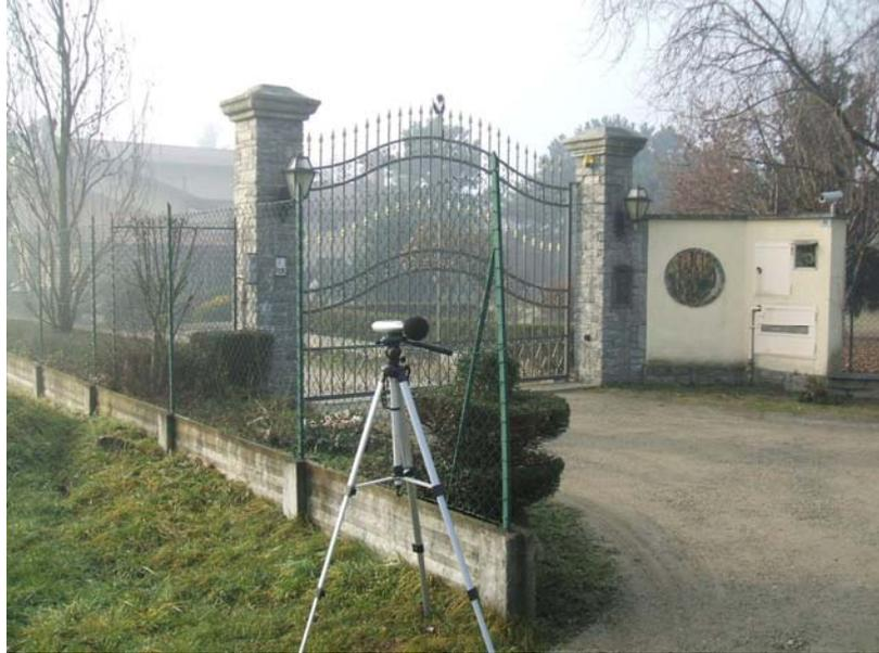
*Posizionamento del fonometro presso il ricevitore PF5*
