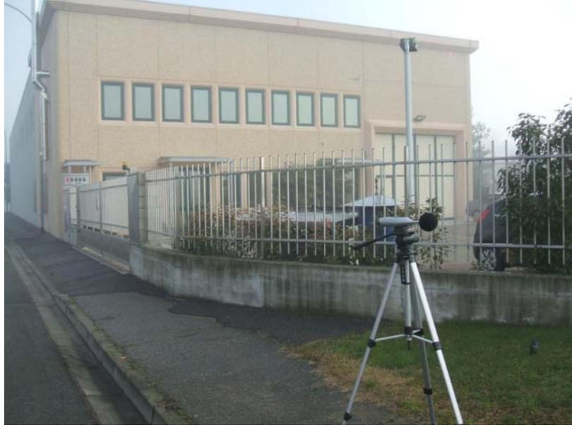
*Posizionamento del fonometro presso il ricevitore PF6*
