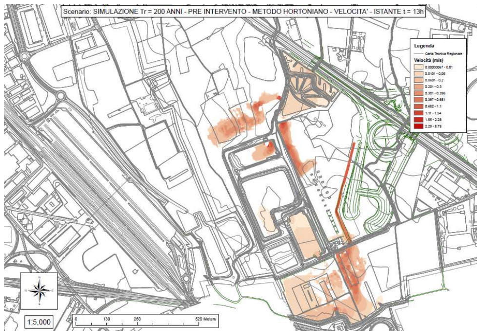
Mappa delle velocità dopo 13 ore di simulazione.
