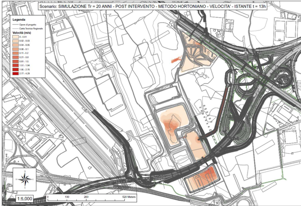
Mappa delle velocità dopo 13 ore di simulazione.
