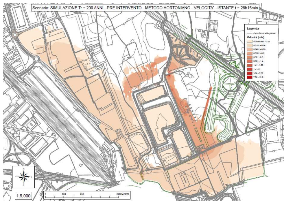
Mappa delle velocità dopo 28h15min di simulazione (sfioro dalla rotonda).
