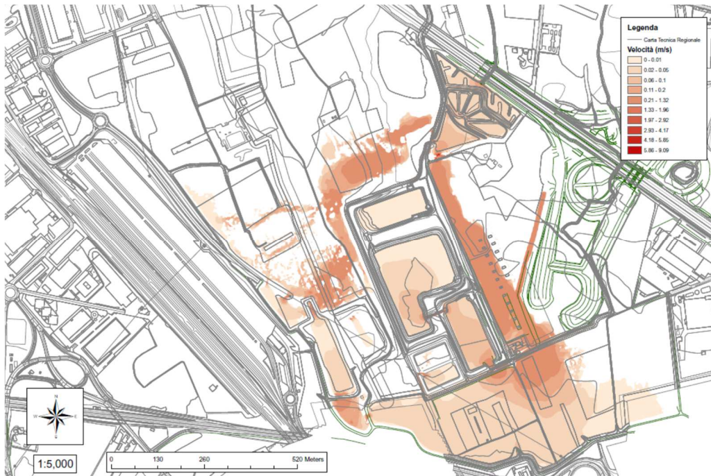
Mappa delle velocità dopo 17h30min di simulazione.
