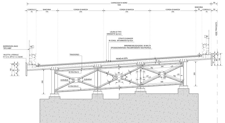
SEZIONE TRASVERSALE IN CORRISPONDENZA DELLE SPALLA B
