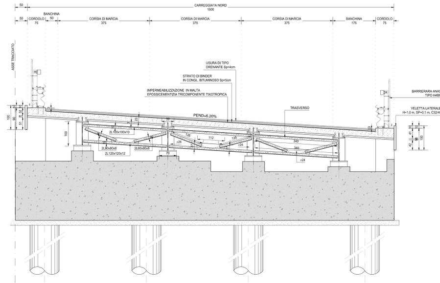
SEZIONE TRASVERSALE TIPO SULLE PILE
