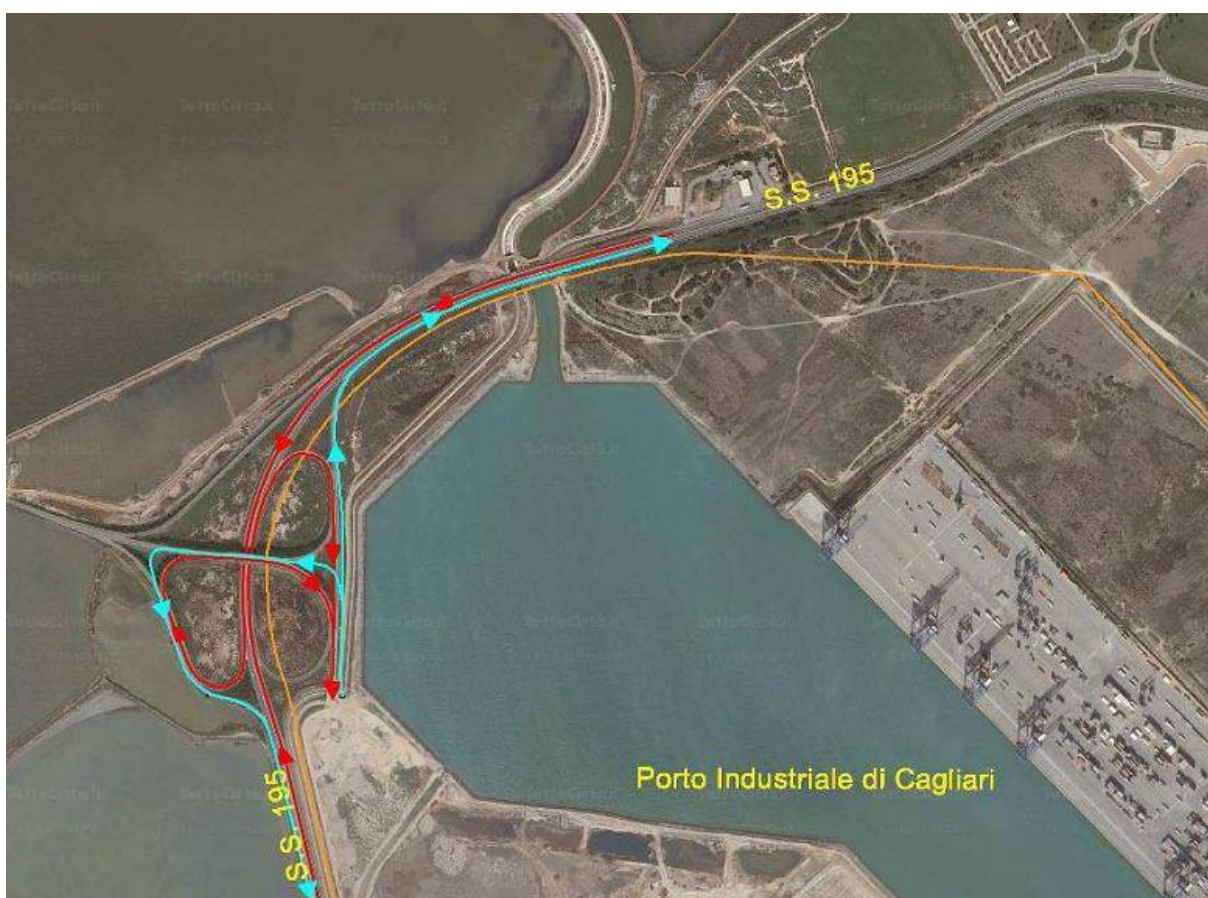
Figura 3-14 Ipotesi di accesso al nuovo terminal Ro.Ro. dal versante opposto quello esistente e localizzato sullo svincolo fra la S.S. 195 e la S.P. 92
