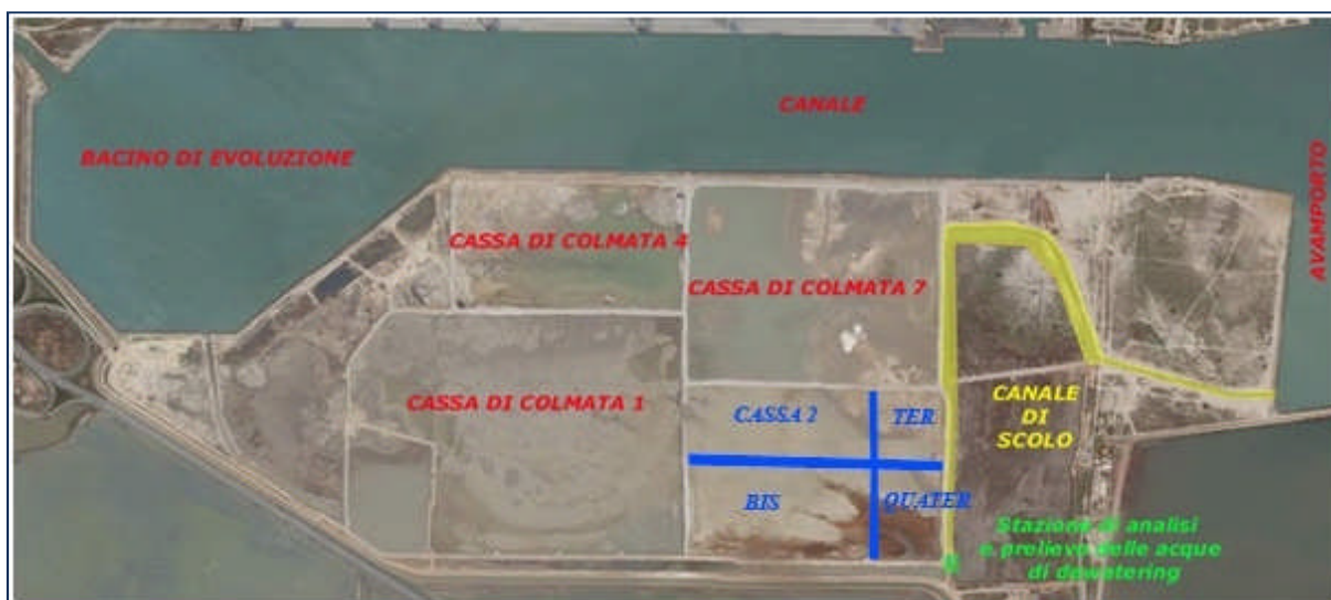
Figura 4-3 Vasca di colmata nell'avamposto ovest del Porto Canale.
