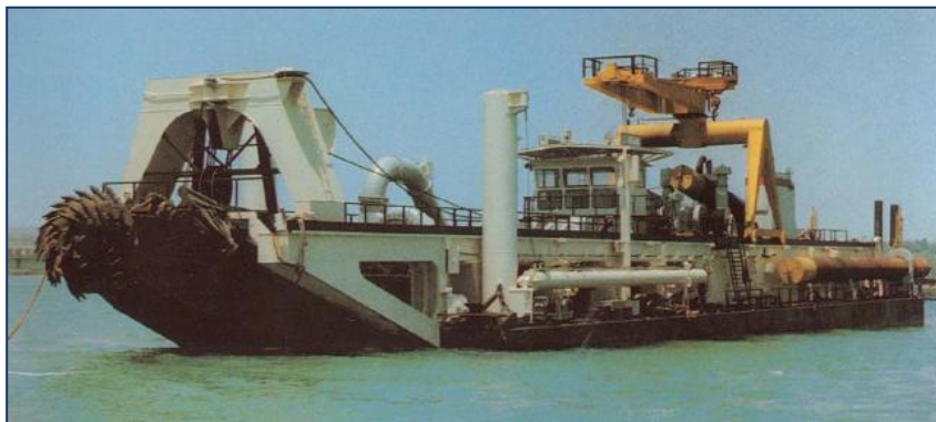
Figura 4-4 Draga aspirante refluyente con disgregatore
