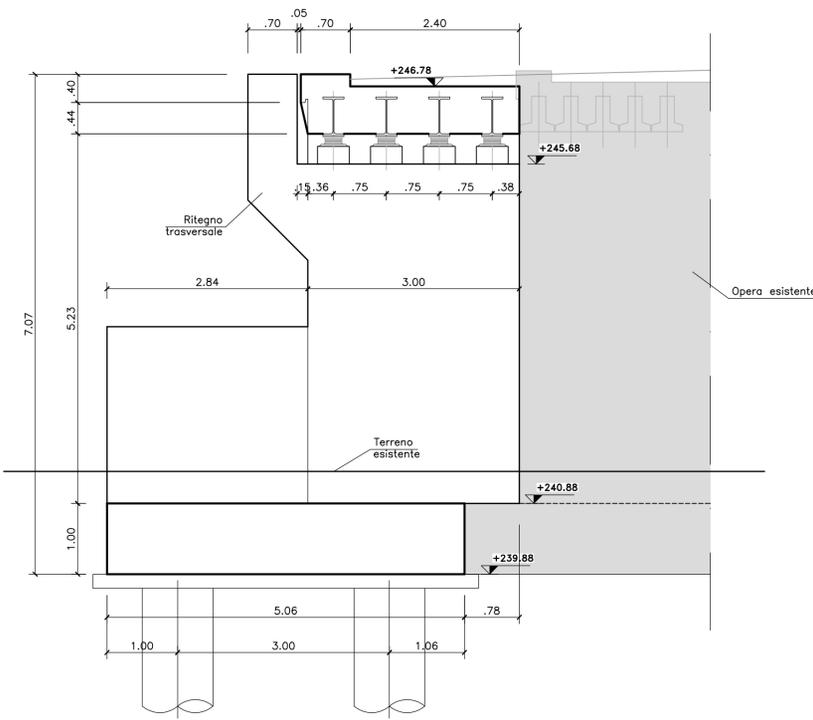
**SEZIONE TRASVERSALE SPALLA B**
