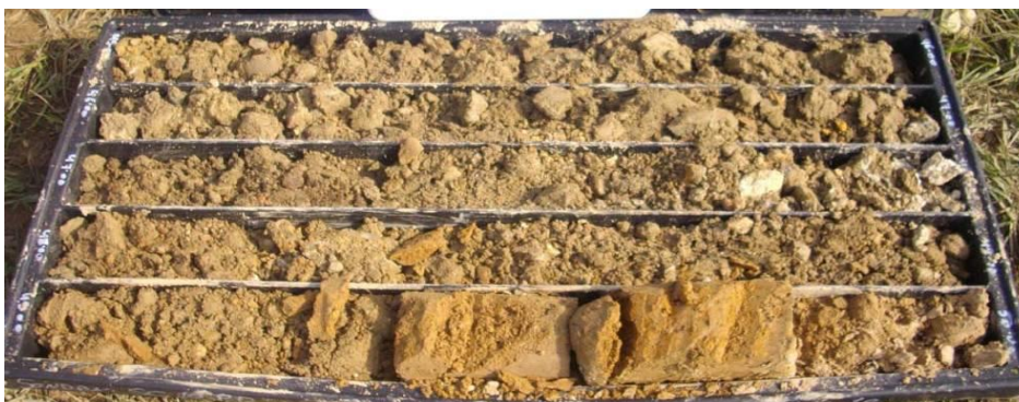
Foto 3/c – Fotografia delle cassette del sondaggio Sc-10-PD realizzato in fase di progettazione definitiva (cassetta n.10 da 45 a 50 m)
