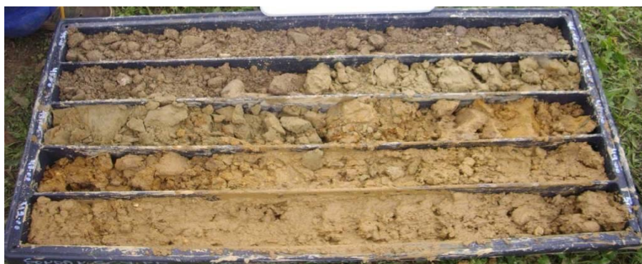
Foto 1/a – Fotografia delle cassette del sondaggio Sc-7-PD realizzato in fase di progettazione definitiva (cassetta n.10 da 45 a 50 m)
