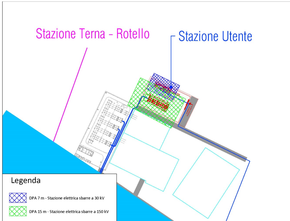
Figura 15 Rappresentazione grafica della DPA stazione elettrica 30/150 kV.
