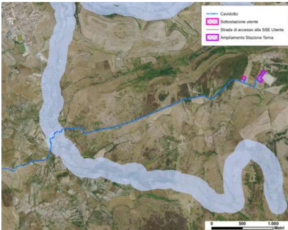
Sovrapposizione del tracciato del cavidotto di distribuzione elettrica d’impianto con la fascia di tutela di 150 m del Riu Camedda
