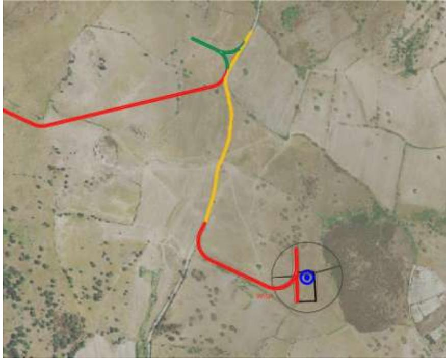
*Progetto strada di accesso alla turbina WTG01 nel progetto definitivo a valle di un confronto dal Proponente e il proprietario.*
