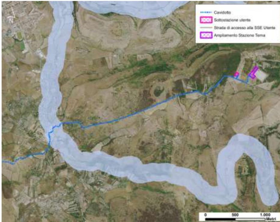
*Sovrapposizione del tracciato del cavidotto di distribuzione elettrica d'impianto con la fascia di tutela di 150 m del Riu Camedda*
