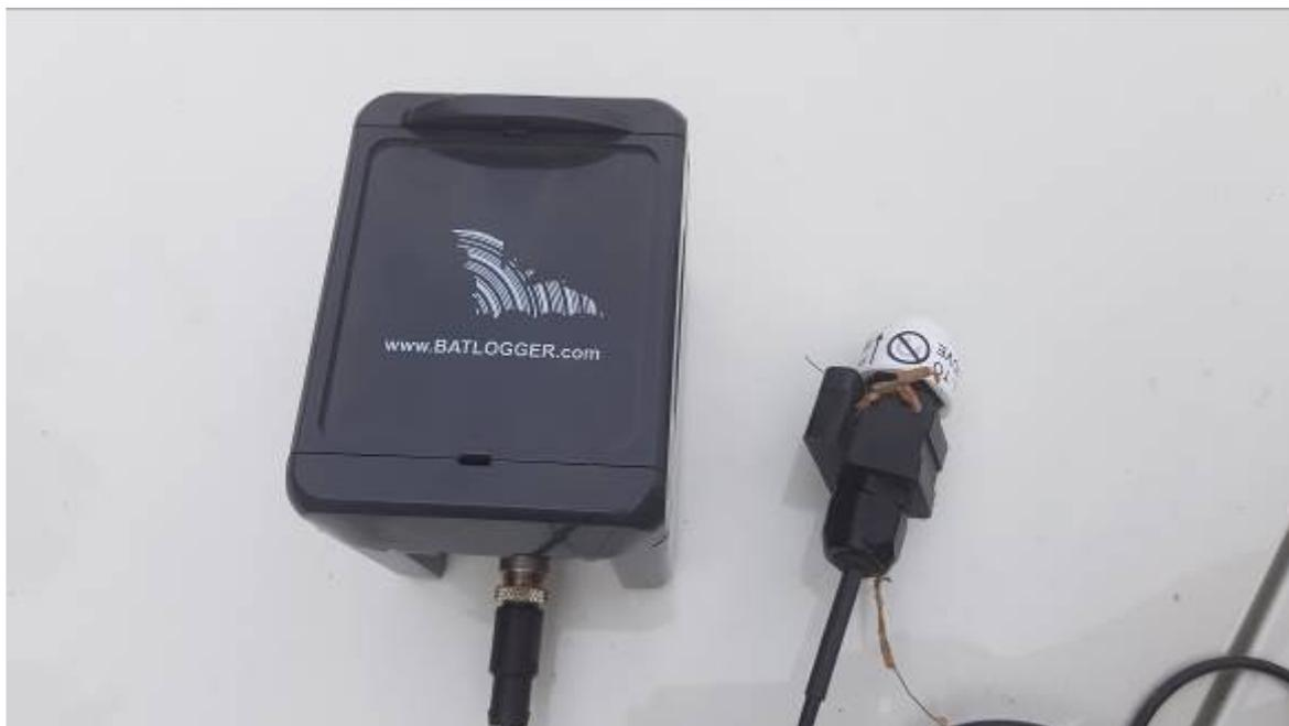
*Figura 4.3.8/A: il modello di bat detector utilizzato per il monitoraggio dei chiroterteri*
