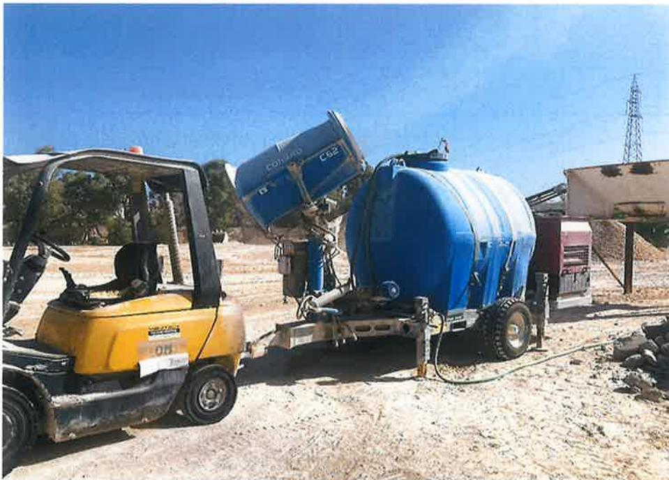
**Figura 2 - Cannone nebulizzatore per l'abbattimento delle polveri**
