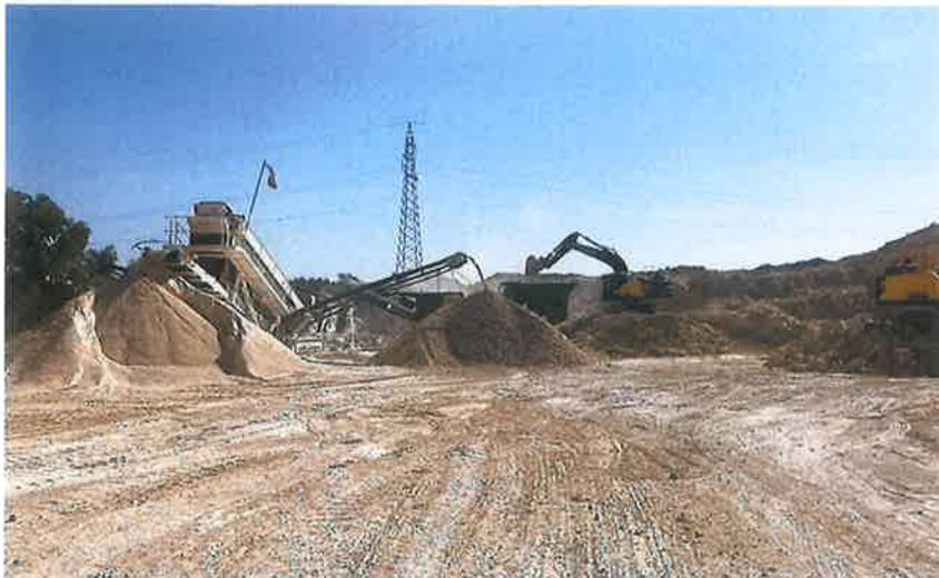
**Figura 4 - Sistema di lavorazione frantoio-vaglio alimentato con escavatore con benna rovescia**
