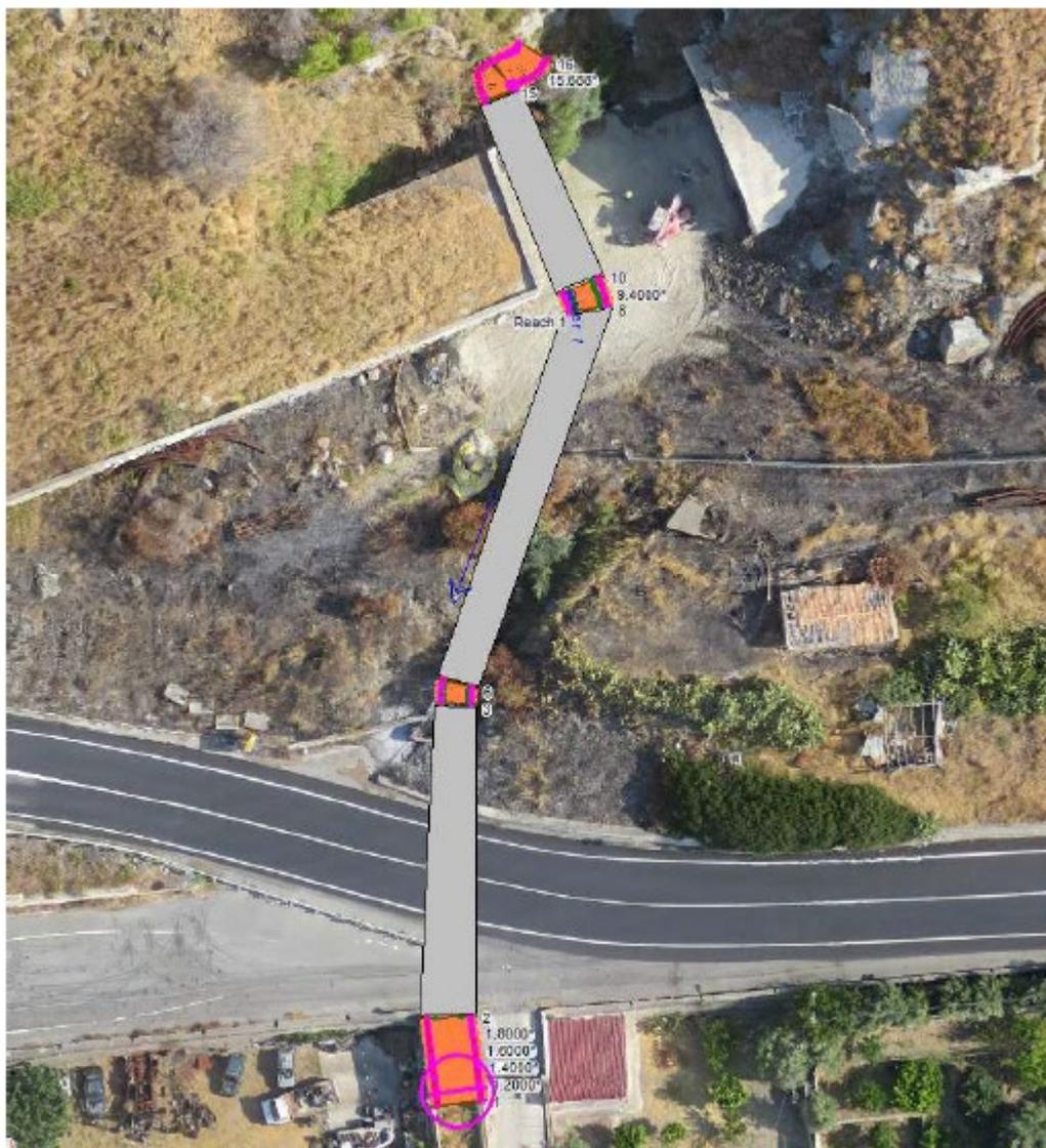
Figura 7: Simulazione idraulica del sistema di tombini OPI01 – OPI01BIS : geometria implementata nel software HEC-RAS
