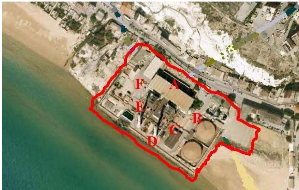
Figura 8-3 Punti di misura relativi alla sorgente sonora
