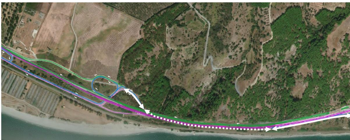
Figura 62 - Stralcio schema viabilità S.S.106 esistente, variante S.S.106 all'abitato e viabilità locale, nella Macro fase 3
