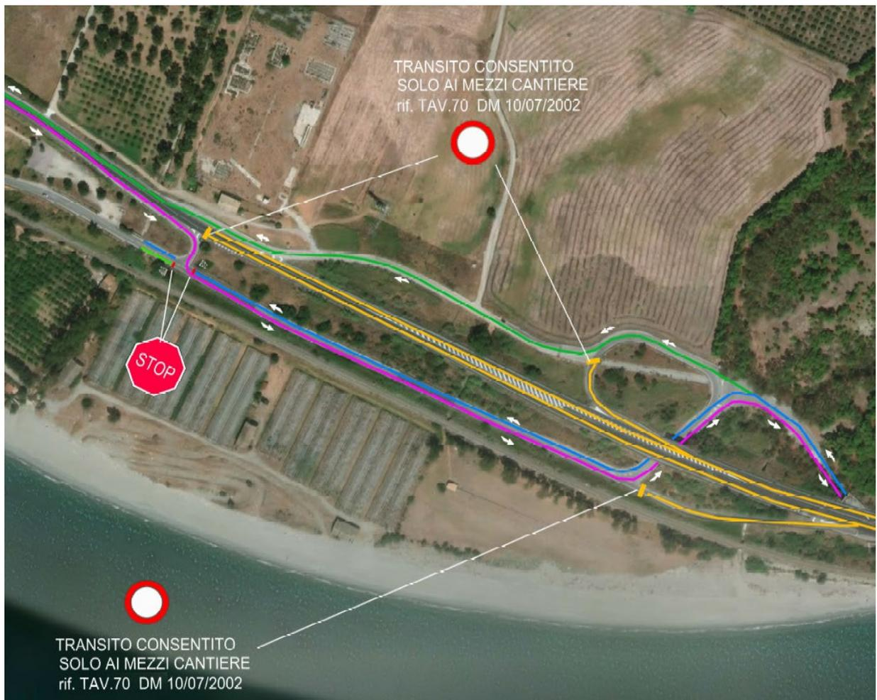
Figura 61 – Stralcio schema viabilità alternativa per i flussi veicolari RC-TA e TA-RC e flussi di cantiere nella Macro Fase 2
