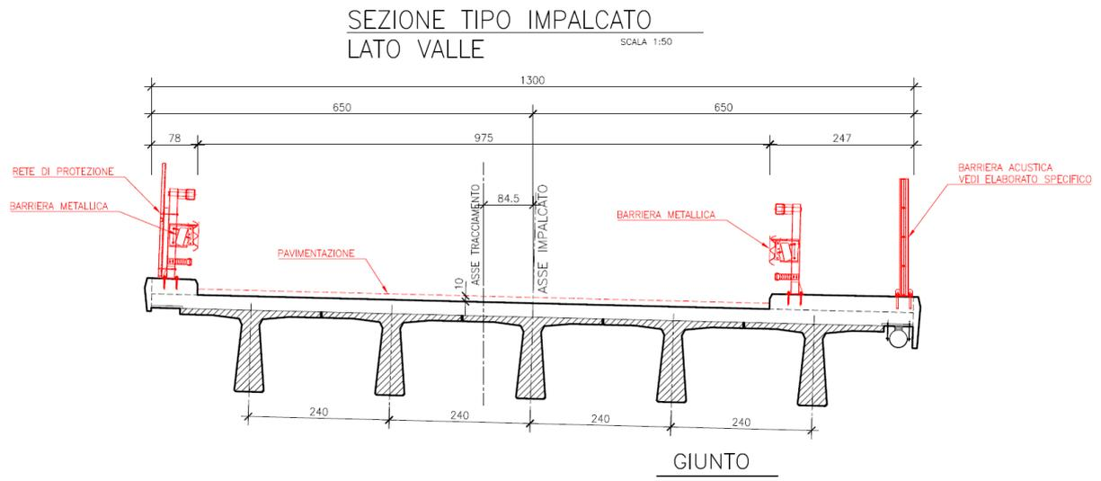
Figura 35 – Sezione tipo impalcato Viadotti Simmero e Fiumara Palizzi con opere di finitura da completare
