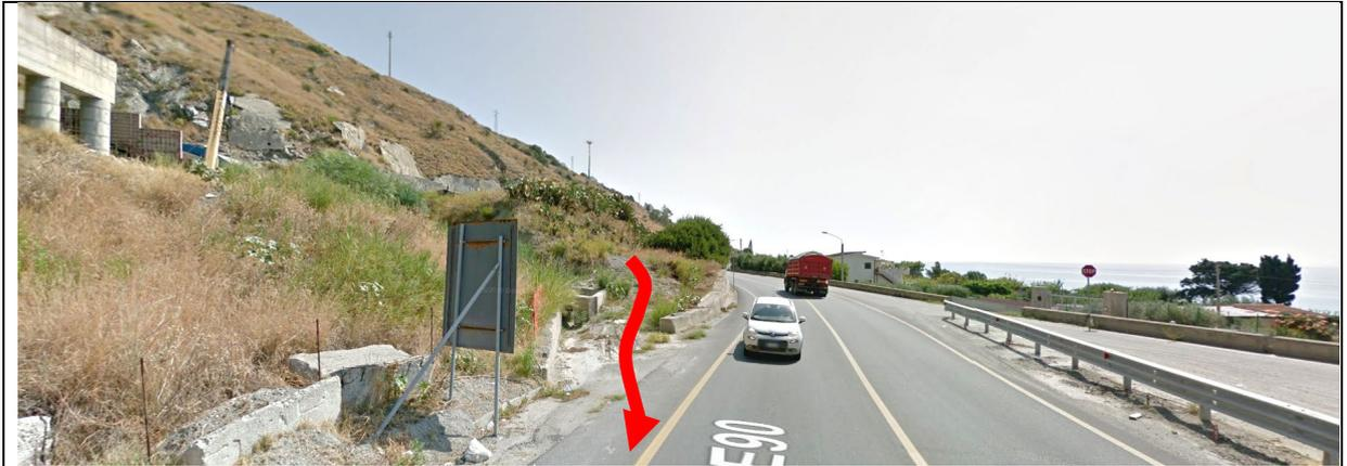
L'ingresso e l'uscita all'area di stoccaggio avverrà per mezzo di un'intersezione a raso adeguatamente proporzionata per la tipologia di mezzi in entrata e in uscita direttamente sulla SS 106 esistente. L'area risulta già di proprietà ANAS.
