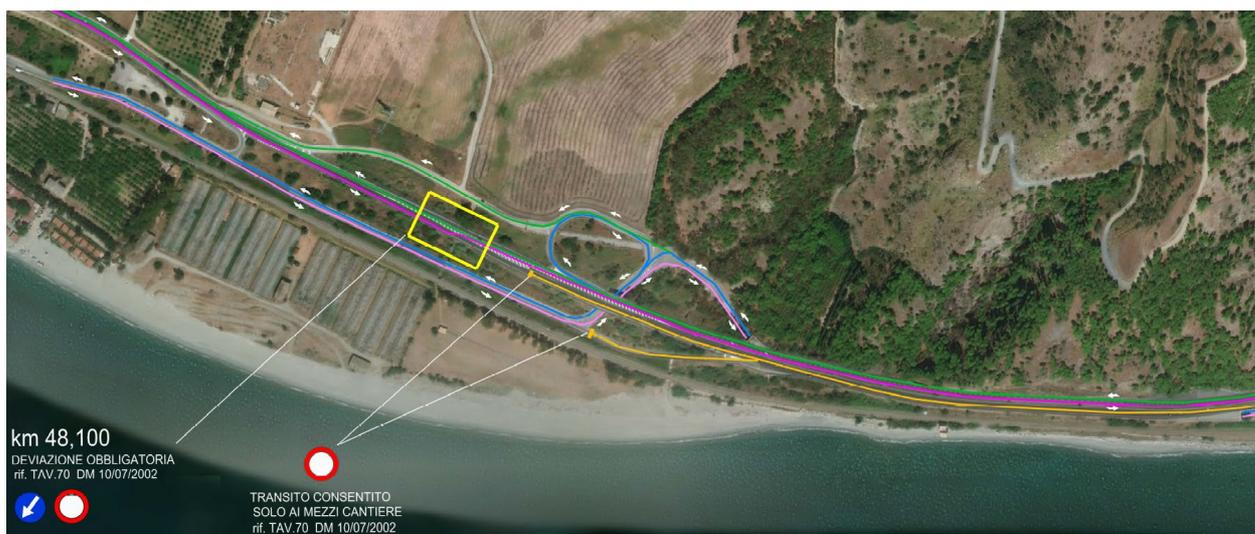
Figura 60 – Stralcio schema viabilità alternativa per i flussi veicolari RC-TA e TA-RC e flussi di cantiere nella Macro Fase 1
