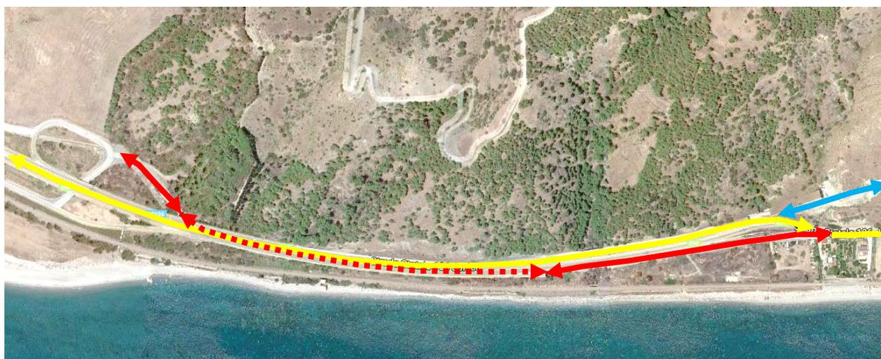
Figura 58 – Tratto vecchia S.S.106 in galleria (in rosso) attualmente dismessa di cui si prevede il ripristino in altro appalto, S.S.106 esistente (in giallo) e Carreggiata di monte (in blu)
